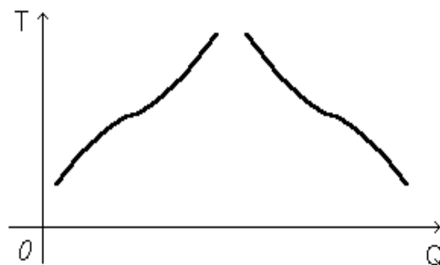
Рис. 4. Кривые плавления аморфного тела.
