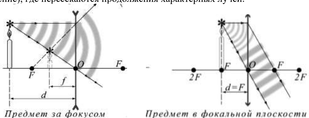
Рис. 4. Построение изображений в рассеивающей линзе.
