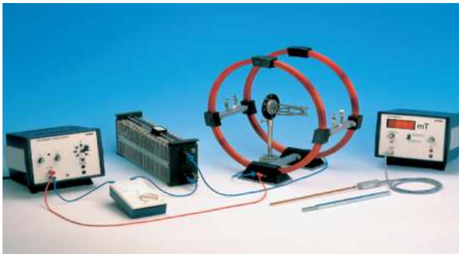
Рис.4. Экспериментальная установка по определению индукции магнитного поля Земли
