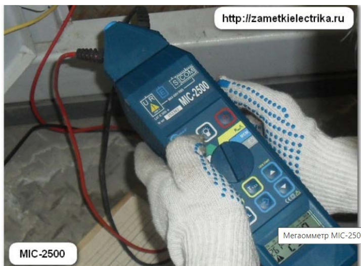
Рисунок 28 – М4100/5 в карболитовом «чемоданчике» и МІС-2500 от Sonel.
