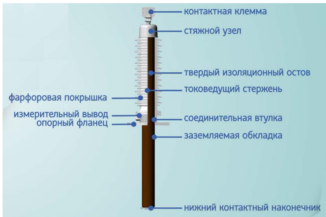
Рисунок 3 – строение высоковольтного ввода
