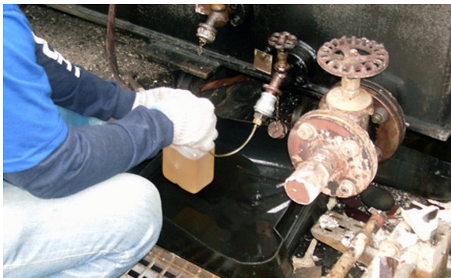
Рисунок 13 – Отбор пробы трансформаторного масла
