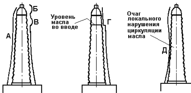
Рисунок 10.2 – Характер распределения температуры по высоте маслонаполненного ввода: нормальное распределение температуры (А); распределение температуры при наличии короткозамкнутого контура в маслорасширителе (Б); при перегреве внутренних контактных соединений (В); при понижении уровня масла (Г); при нарушении циркуляции масла (разбухание бумажного остова на токоведущем стержне, шламообразование и т.п.) (Д).
