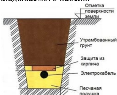
Рисунок 6.3 – Прокладка кабеля в траншее
