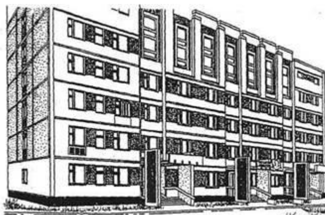
Рис. 2.7. Крупнопанельное административно-бытовое здание с высотой типовых этажей 2,8 м. Общий вид
