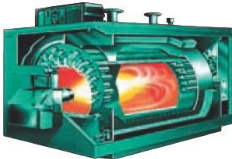
Рисунок 0.1 – Схема работы и устройства котла КСВ 0,1÷0,5 МВт
