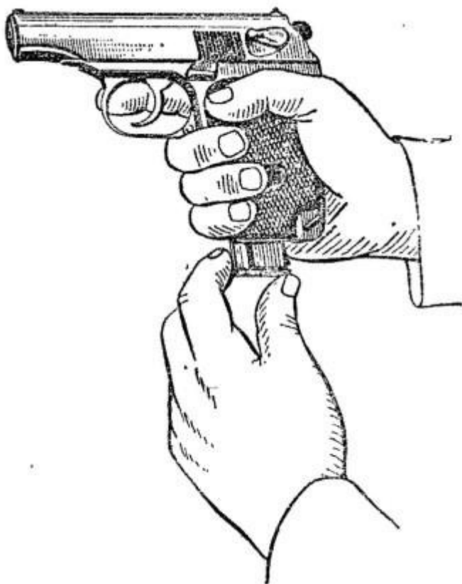
Рис. 8. Вставление магазина в основание рукоятки
