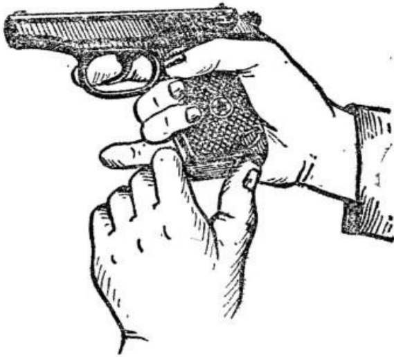
Рис. 3. Извлечение магазина из основания рукоятки
