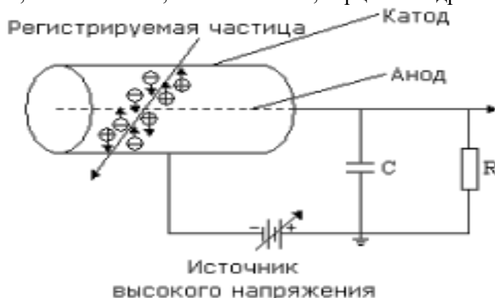
Рисунок 2. 4 – Принципиальная схема конструкции ГС
