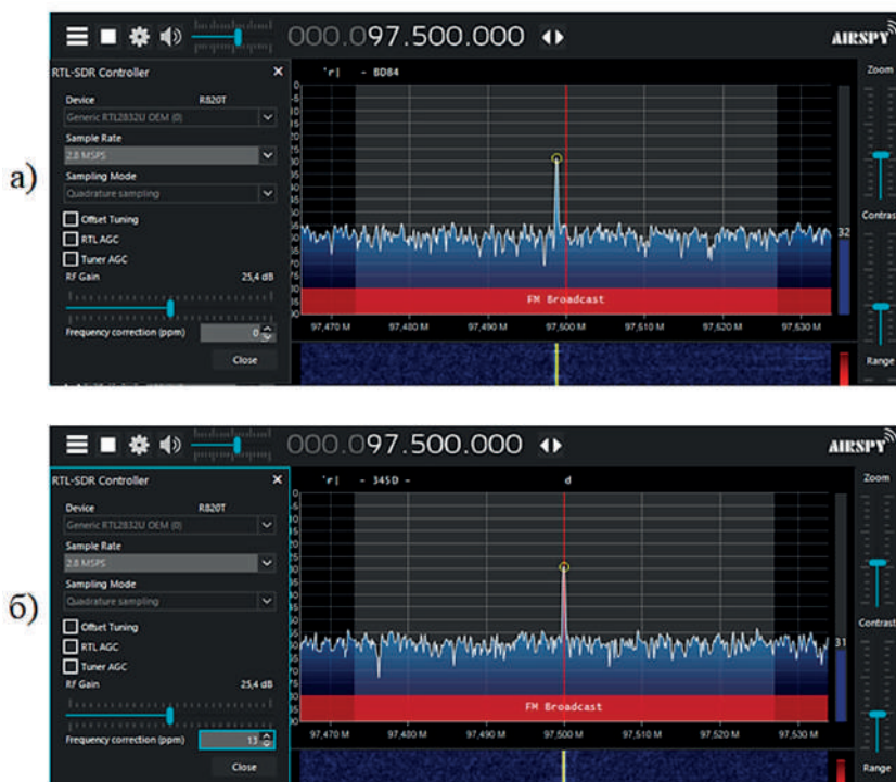
Рис. 23. Принцип частотной калибровки RTL-SDR тюнера
