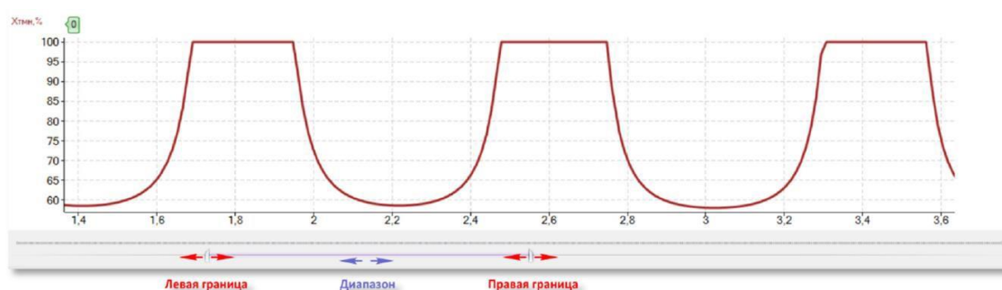
Рисунок 8.8 – Пример графика изменения сопротивления АЛАР
