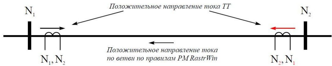
Рисунок 8.1 – Положительные направления токов в модели линии
