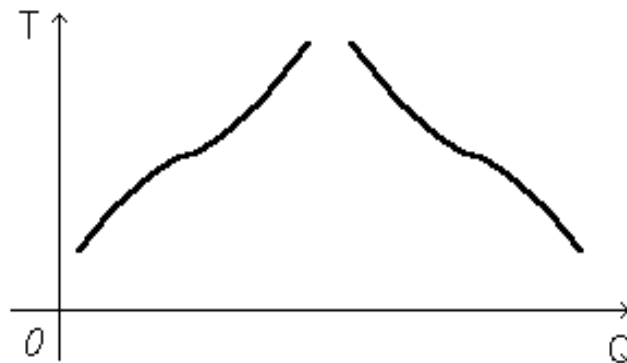
Рис. 4. Кривые плавкости аморфного тела.
