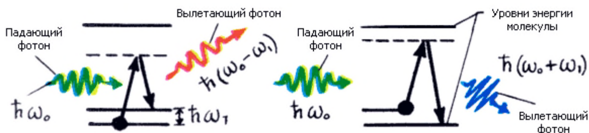
Рисунок 2 – Квантовая картина комбинационного рассеяния света
