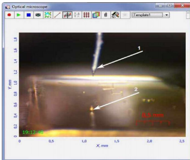
Рисунок 13 – Видеоизображение, 1 – зонд; 2 – отражение зонда
