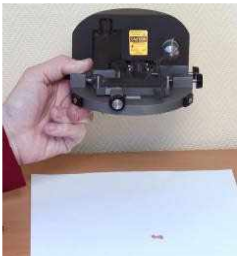
Рисунок 33 – Наведение лазерного луча на кантилевер
