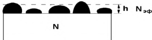
Рисунок 3 – Отражение света от островковых плёнок
