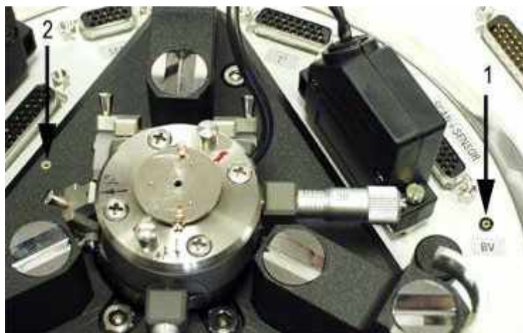
Рисунок 44 – 1 – Гнездо для подачи напряжения смещения; 2 – гнездо заземления
