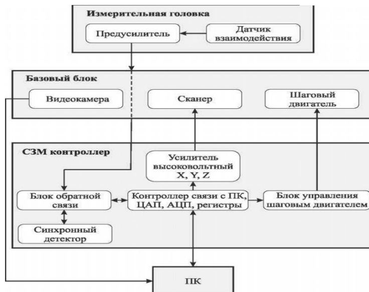
Рисунок 6 – Схематическое изображение управления СЗМ НАНОЭДЮКАТОР II
