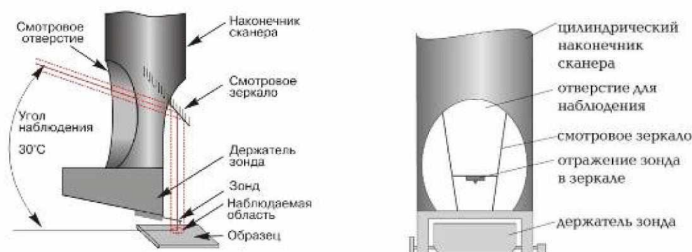
Рисунок 50 – Схема наведения лазерного луча на кантилевер
