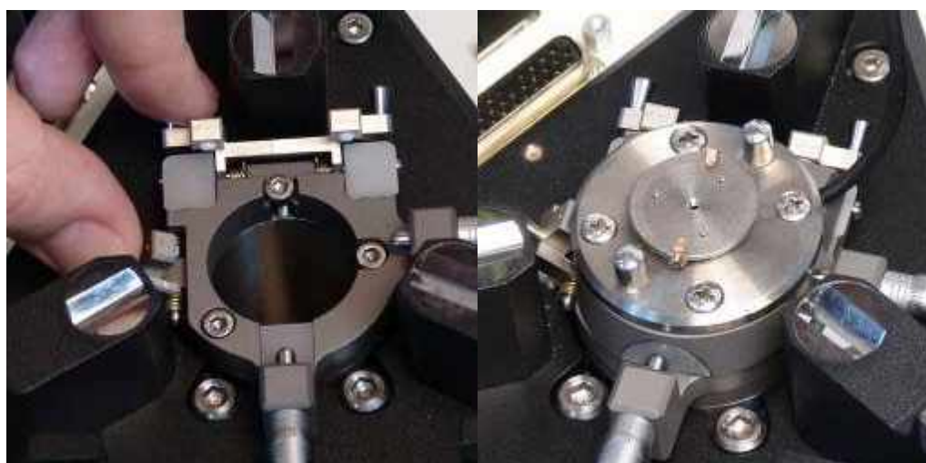
Рисунок 2 – Схема размещения сканера в позиционер механизма подвода, расположенный на сменном основании базового блока
