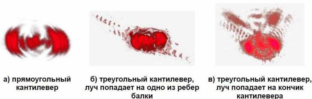
Рисунок 35 – Изображение пятна при попадании лазерного луча на кантилевер
