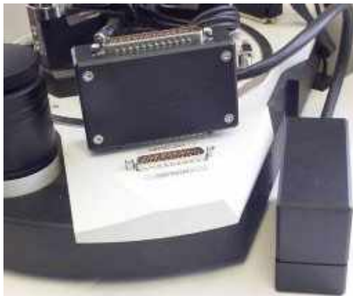
Рисунок 5 – Расположение разъема CONTROLLER 2 на базовом блоке прибора
