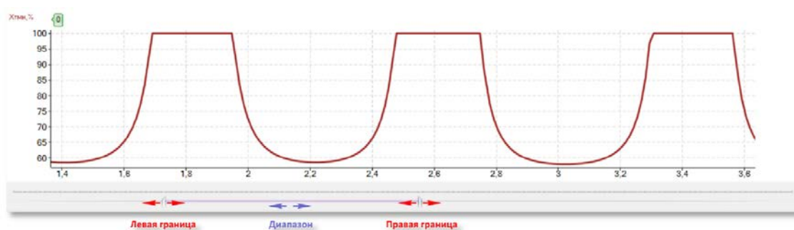
Рисунок 8.8 – Пример графика изменения сопротивления АЛАР
