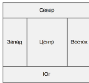
Рисунок 8.8 – Схема расположения областей менеджера BorderLayout.
