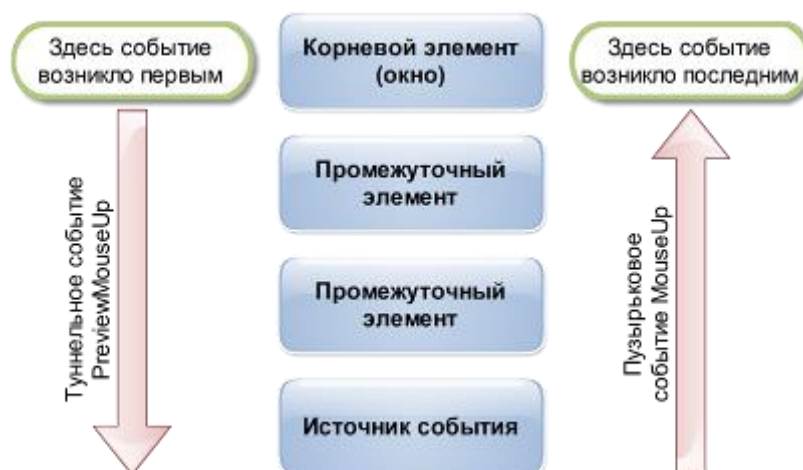
Рисунок 9.15 – Схематичное изображение механизма событий WPF.
