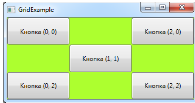
Рисунок 8.28 – Расположение кнопок в контейнере Grid.
