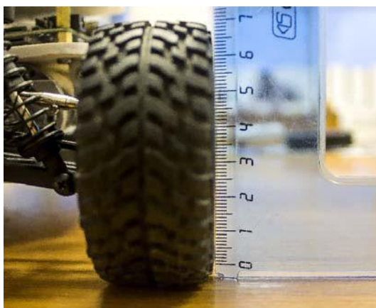
Рис. 2.5.2. Правильный развал задних колёс
