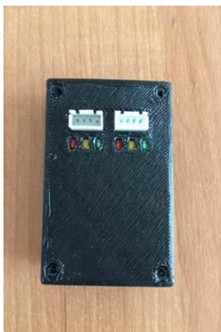
Рис. 2.3.9. Устройство управления светофорами в корпусе
