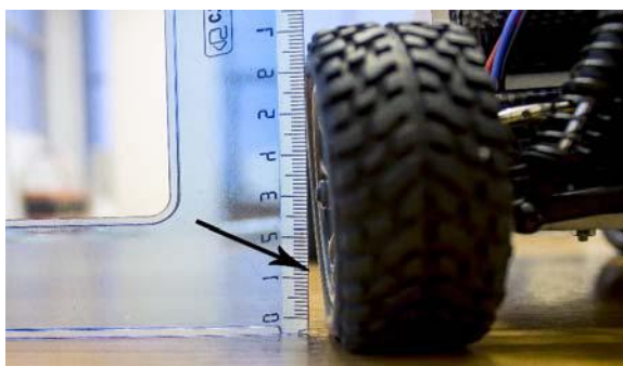
Рис. 2.5.3. Неправильный развал задних колёс
