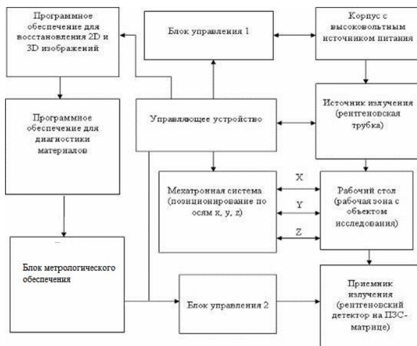
Рис. 3.1.2. Функциональная схема рентгеновского микротомографа (PMT)
