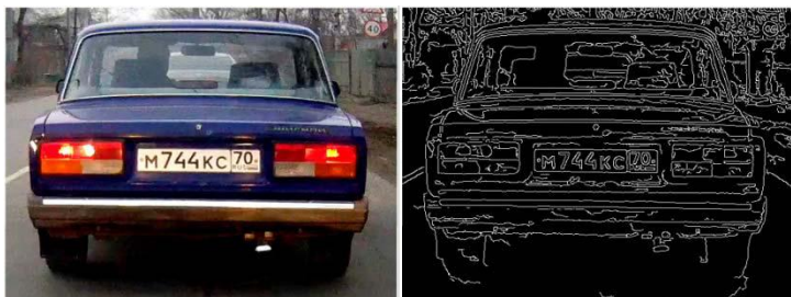
Рис. 1.4.2. Определение искомой области номера автомобиля
