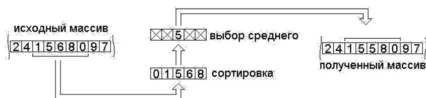
Рис. 1.1.6. Принцип осуществления медианной фильтрации
